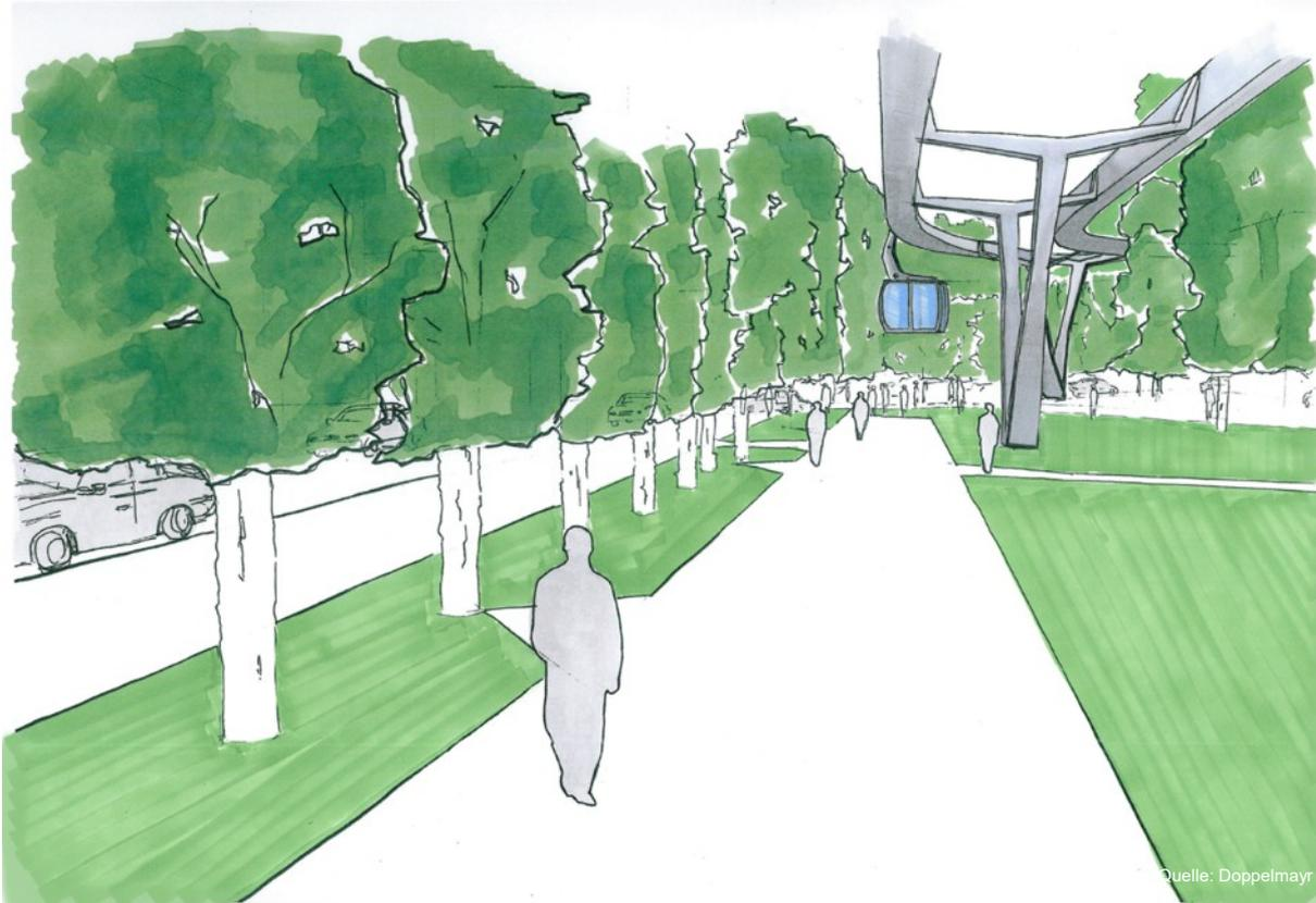
Seile **können** mit Hilfe einer Tragwerkskonstruktion auch **dem Straßenraum folgen**.
